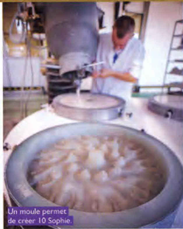
Le caoutchouc, encore mélangé à de l'eau, est versé dans le moule en plâtre.
